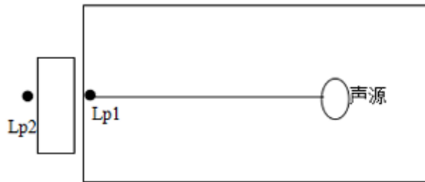
图 4-1 室内声源等效为室外声源图例
